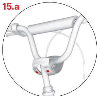
15.a Установка защитных чехлов (Two, One)
