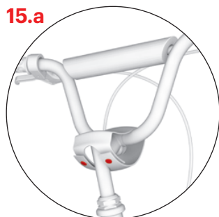
15.a Instalación de las cubiertas protectoras (El modelo Two/One)
